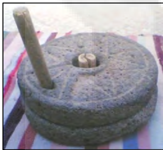
شکل ۲: نمونه‌ای از یک آسیای دستی که محور مرکزی آن، قطب و دسته چرخنده سنگ آسیا، تبر نامیده می‌شود.
