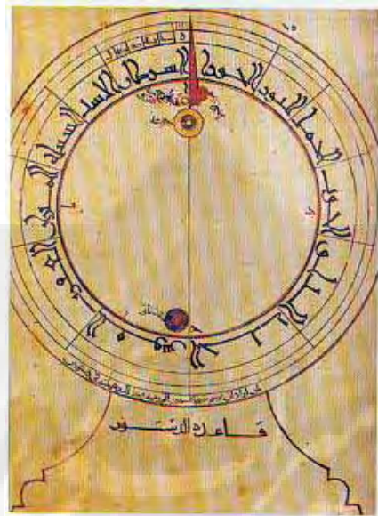
شکل ۱۵- تصویر از جلوی قرص صفحه تنظیم با علائم برج‌های دوازده‌گانه، شاخص و انتهای خروجی لوله آب (دست‌نوشته A ۳۴۷۲، برگ ۸ر)
