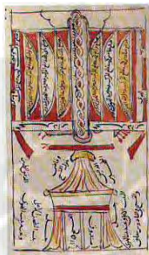
شکل ۱۷- دست‌نوشته‌ای از شمس‌الدین ابو عبدالله محمد بن ابی طالب انصاری دمشقی (۶۵۴ - ۷۲۷ق) که سطح مقطع یک آس‌باد را نشان می‌دهد، آس‌بادی که به صورت عمودی با یک محور عمودی می‌چرخد.
