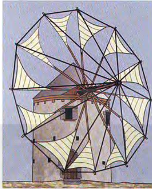
شکل ۱۹- جهت باد و فاصله سنگ در آس باد مدیترانه‌ای دستی کنترل می‌شد.
